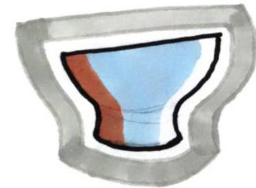
Para producirlo en serie el prototipo puede servir de modelo para hacer moldes de escayola y verter la cerámica por colada.
